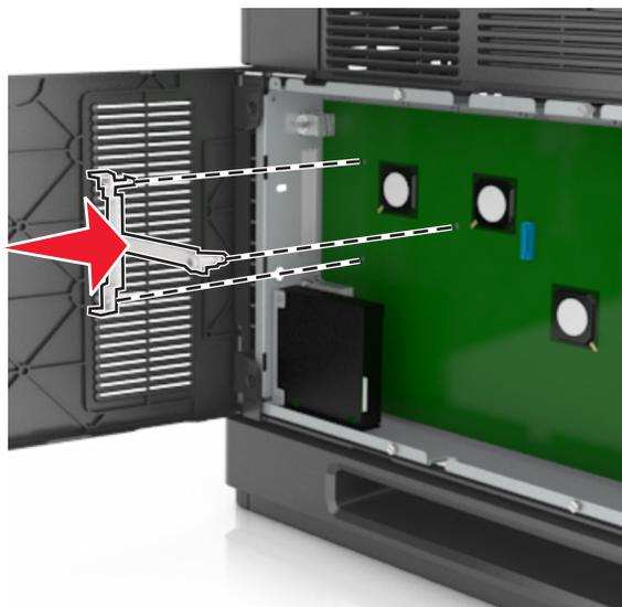
**Remarque :** Vérifiez que le support en plastique est bien enclenché et qu'il est correctement placé sur le boîtier.
