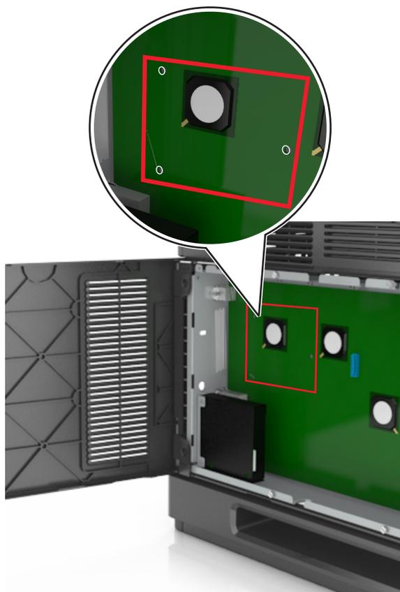
**Remarque :** Si un ISP optionnel est installé, le disque dur de l'imprimante doit être installé sur cet ISP.
